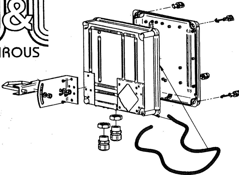
**GentleBOX** je připravený pro montáž běžných AP, RouterBOARDů a pod. Využijte přibalených šroubů a plastových sloupků pro montáž do základní části nebo do víka! Podrobnosti naleznete na [www.jirous.com](http://www.jirous.com)
